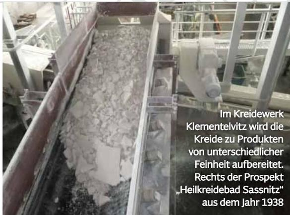
Im Kreidewerk Klementelwitz wird die Kreide zu Produkten von unterschiedlicher Feinheit aufbereitet. Rechts der Prospekt „Heilkreidebad Sassnitz“ aus dem Jahr 1938
